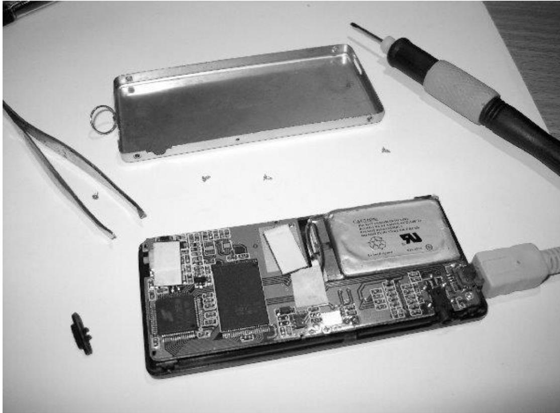
٦- إستخدم أحد الملاقط المناسبة وبرفق قم بعمل توصيل بين أرجل الـ IC من جهة واحدة وقد تحتاج لعمل ذلك لعدة مرات حتى يشعر بها جهاز الكمبيوتر ويعطيك رسالة كما هو موضح بالصورة التالية .
